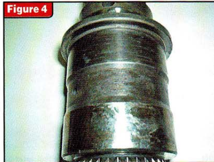
Brinelling of mainshaft sprocket journal
